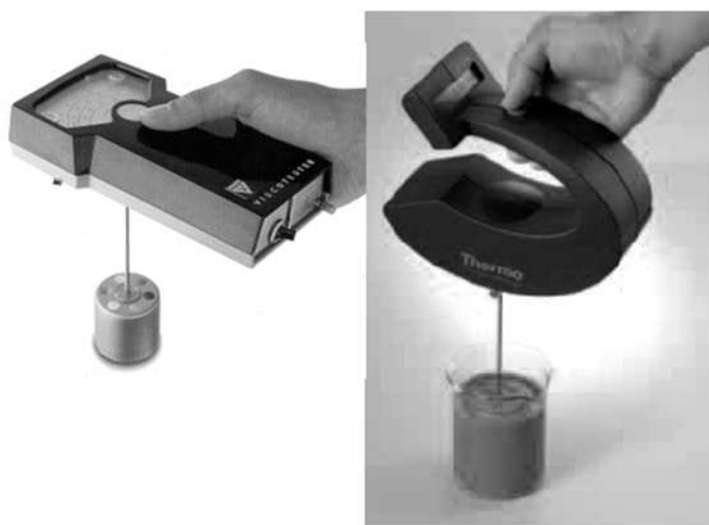
图 2.2 模拟式黏度仪（左）和数字式黏度仪（右）
