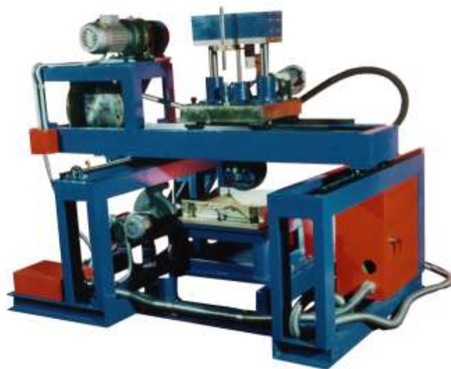
图 T 0719—1 车辙试验机
