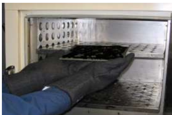
图 2.15 将平板放入烘箱内使结合料均匀地分布在平板上
