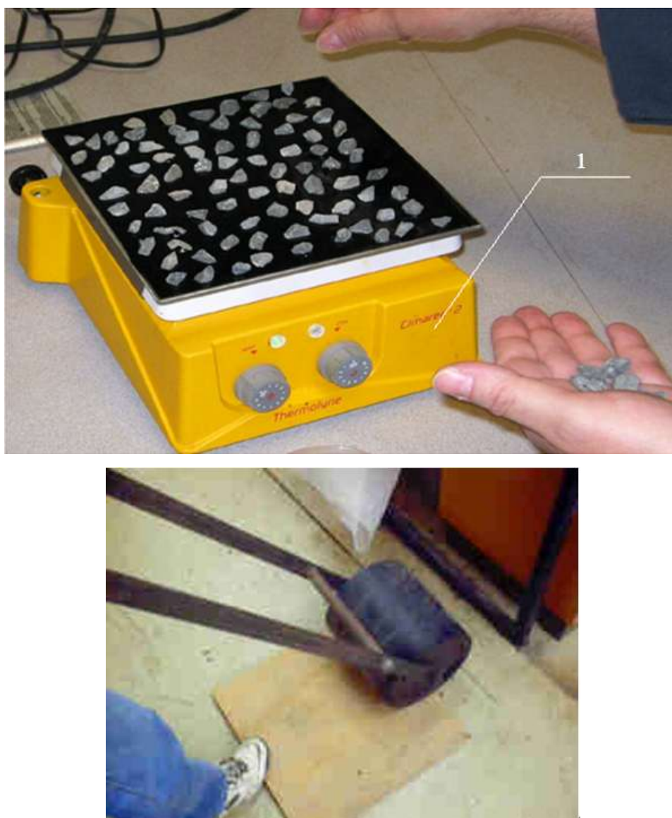
图 2.16-2 将瓦楞纸板覆盖在平板的石屑上方后再用橡胶滚轮进行碾压
