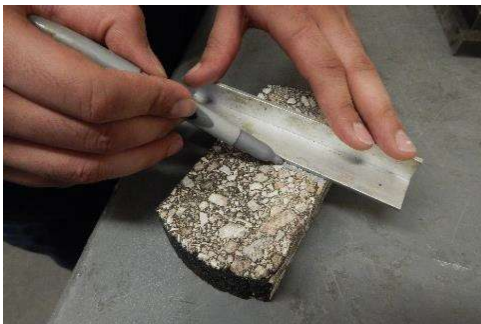
图 6-用马克笔标记试件中线
