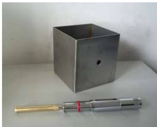
图 J.1.2-3 贯入试验仪
